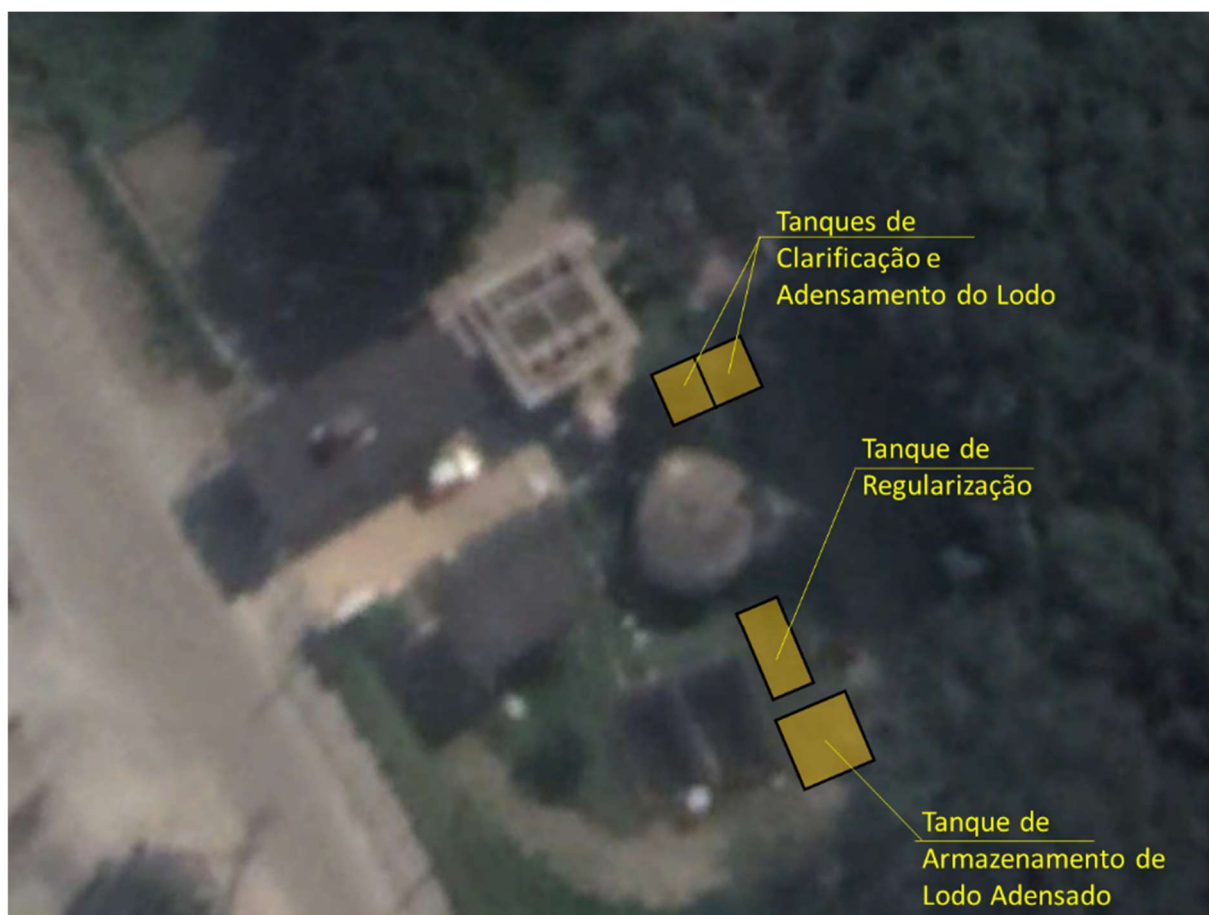
Figura 64 - Layout preliminar proposto para a implantação do sistema de tratamento dos efluentes
