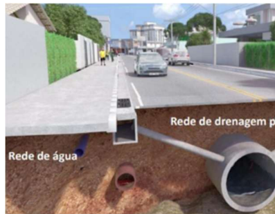
Figura 59 – Sarjetas, bocas de lobo e galerias tubulares
